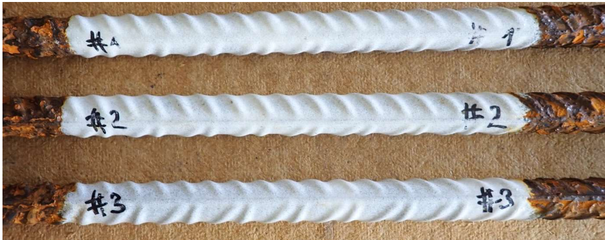
Abbildung 10: Nach 240 Stunden NSS-Test zeigen die Anker im betrachteten Bereich keine Korrosionsmarken oder Risse der Beschichtung.
