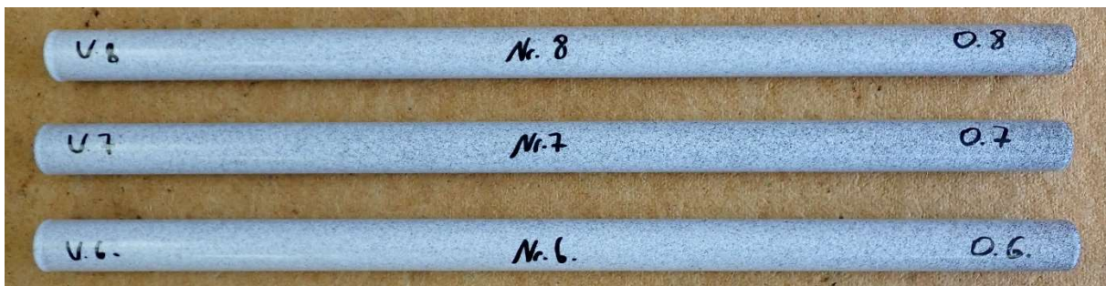
Abbildung 4: Dübel mit Kunststoffbeschichtung vor dem NSS-Test.
